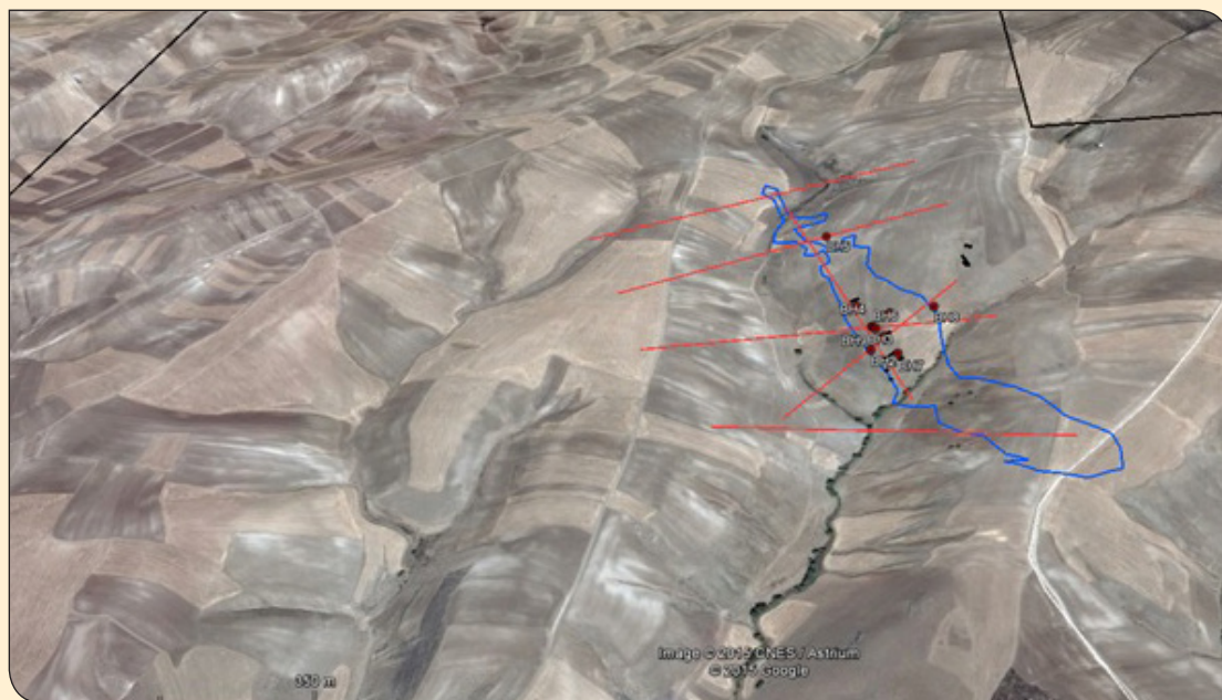
پروفیل های (خطوط قرمز) ، آنومالی مغناطیسی (پلی گون آبی)، ترانشه ها و گمانه های حفاری شده در محدوده اکتشافی
